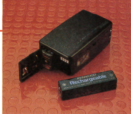
Le batterie ricaricabili Kenwood sono a forma di parallelepipedo anziché cilindrica. A meno di non avere un caricabatterie in grado di accoglierle, per la ricarica è necessario usare il BP-A7.
