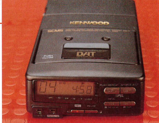
Il display, visualizza cifre molto grandi ma non è illuminato e non reca indicazione permanente del livello di registrazione.
